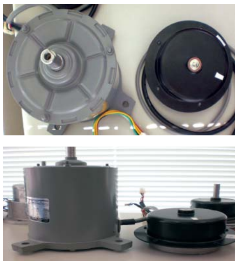
新開發直流無刷馬達與 AC 馬達外觀比較圖：
